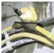
La manta MRSM es ideal para reparar chaquetas de cables mineros flexibles. La superficie externa de la manta viene con una pintura termocromática que cambia de color durante la aplicación de calor. El adhesivo interior se derrite durante la instalación para lograr una alta adherencia al cable. El cierre de acero inoxidable puede ser retirado una vez que se enfría. La flexibilidad del producto permite manipular el cable con facilidad.
