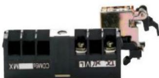
Es utilizada para disparar el interruptor de un punto remoto, cuando el circuito de la bobina es energizado. El interruptor debe disparar cuando hay tensión entre un 70 a 110% de la tensión nominal de la bobina.
